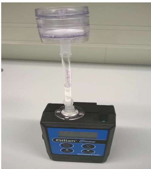
Kuva 1. XAD-putken ja filtterikotelon liittäminen pumppuun
