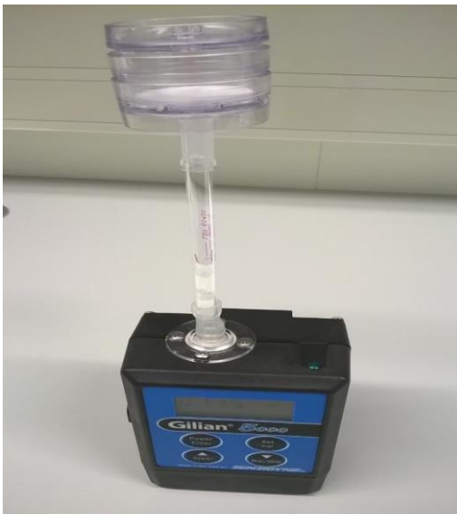
Kuva 1. XAD-putken ja filtterikotelon liittäminen pumppuun
