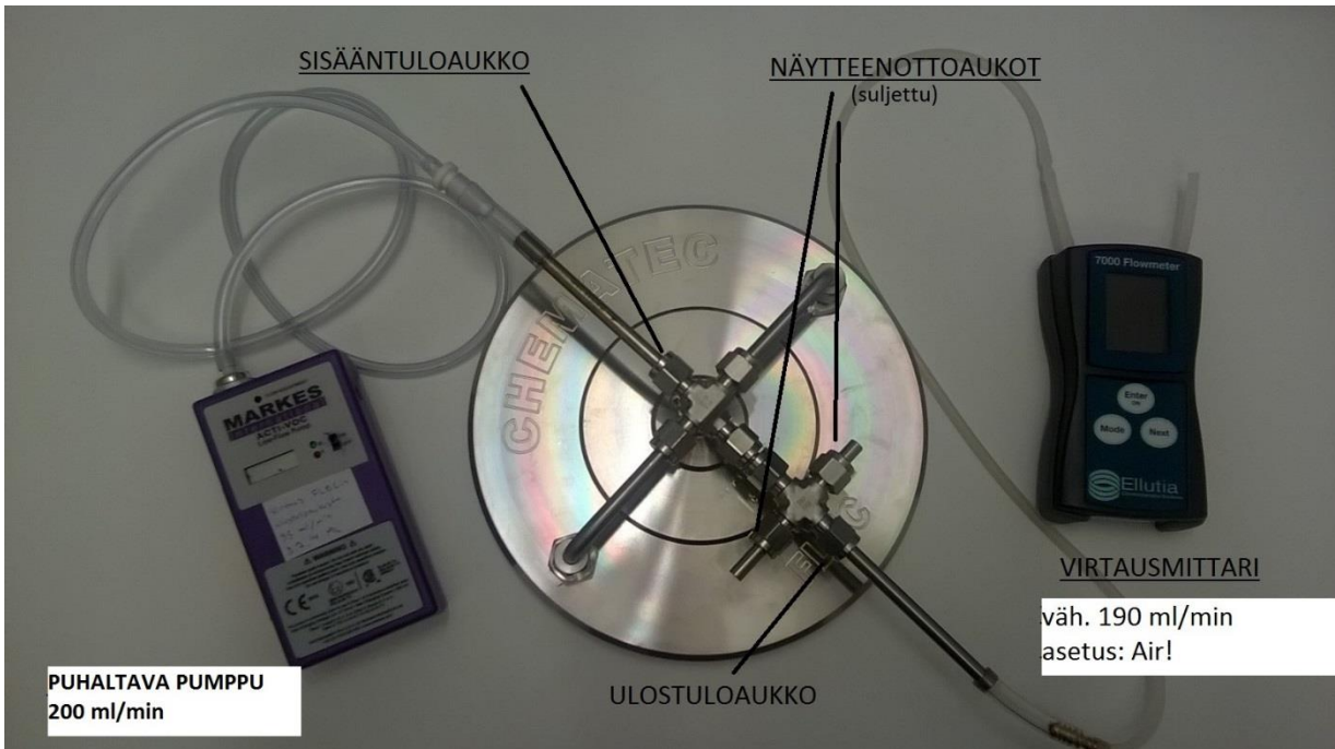
Kuva 1. Kuvun huuhtelu (vaihe 1) ja tuuletus (vaihe 2)
